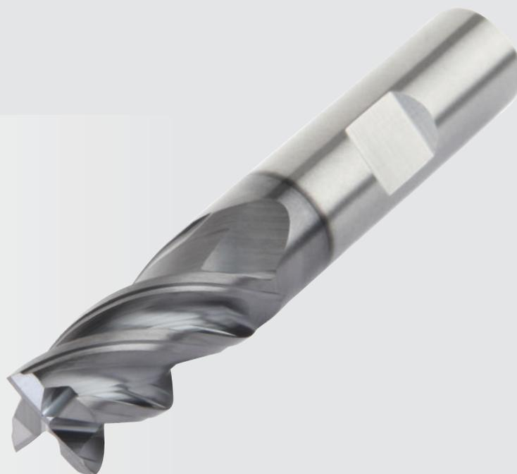
Запатентованная конструкция режущей части с криволинейной режущей кромкой повышает стабильность обработки углов, обеспечивая плавное резание даже при самых больших углах врезания.
