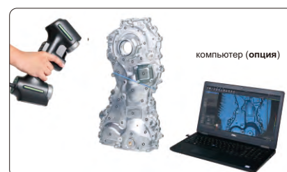
сканирование глубоких отверстий: 1 синяя лазерная линия
